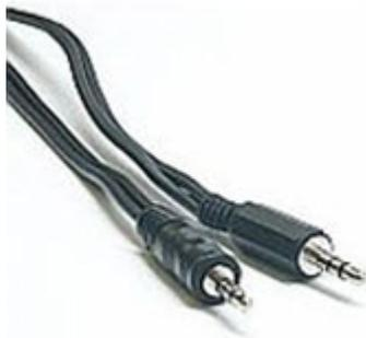
Una vez tenemos el cable lo conectamos desde la salida de auriculares de la emisora o receptor hacia la entrada de micrófono, o mejor aún a la entrada de línea de la tarjeta de sonido de nuestro ordenador. Lógicamente al conectarlo a nuestro equipo éste se queda mudo pero al usar la conexión de la tarjeta de sonido debe oírse el audio por los altavoces del PC, esa es una prueba importante que nos indicará que el nivel de audio del equipo llega correctamente al PC.
